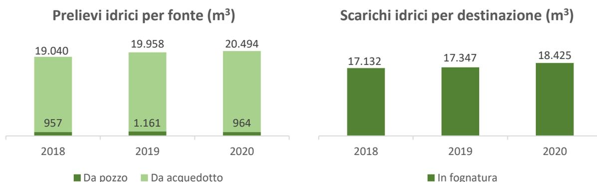
Le acque in uscita dai processi produttivi di ICF, ossia provenienti dalle operazioni di lavaggio degli impianti, vengono trattate e riadoperate in sito laddove tecnicamente possibile. In particolare, le acque di lavaggio degli impianti vengono inizialmente convogliate in un impianto di trattamento primario e successivamente trattate tramite osmosi inversa per poi essere stoccate in appositi serbatoi e riutilizzate nuovamente per il lavaggio degli impianti.
